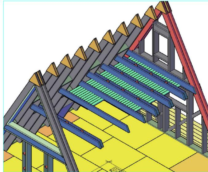
2.Подшиваем потолок ,создавая место для заполнения. Если снизу антрисоли не планируется вообще никаких помещений и звукоизоляция не нужна , то можно сразу перейти к стадии 4. Монтаж отделки потолка ведем в соответствии с выбранной технологией ( предполодим это просто вогонка
